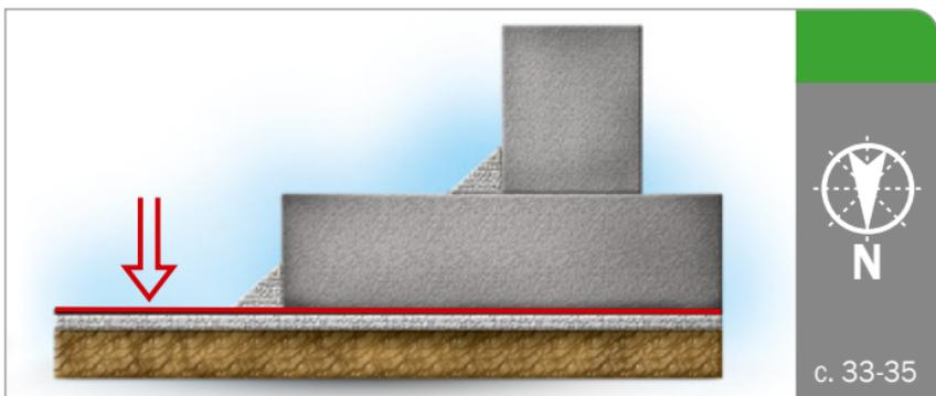
**!** **Важно!** В зависимости от гидрологической ситуации, при которой будет эксплуатироваться строящееся сооружение, а также от квалификации производителя работ, возможна укладка РБМ на горизонтальное основание свободно (без сплошной приклейки к основанию).
